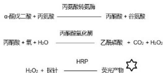
图 1. \alpha -酮戊二酸检测原理图
